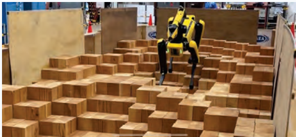
不規則な階段状のフィールド（ステップフィールド）走行試験
