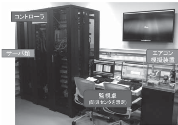
第3図 ビル制御の模擬システム
