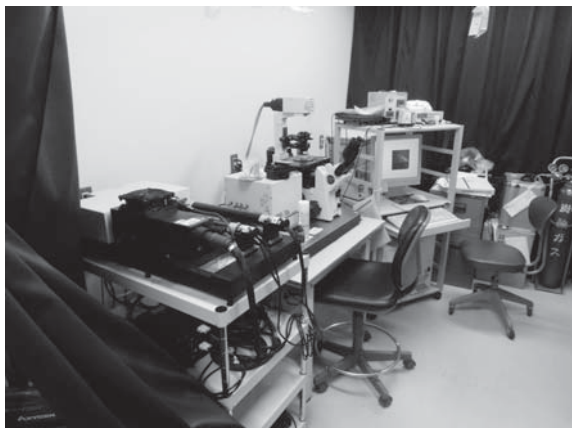
第5図 ピンポイント UV レーザー細胞照射分析システム (東北大学加齢医学研究所安井明教授研究室) 左: UV レーザー、真ん中: UV レーザー照射ヘッド 光学顕微鏡観察部、右: 制御・分析コンピュータ
