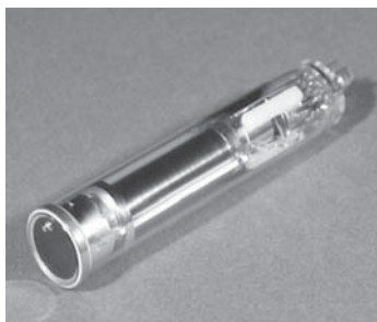
第5図 2/3インチ型 HARP 撮像管
