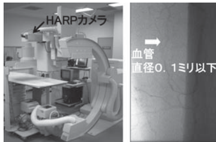
第10図 微小血管 X 線撮影装置と微小血管画像 (国立循環器病センター研究所)
