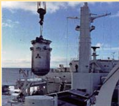
「むつ」への原子炉容器吊り込みの様子
