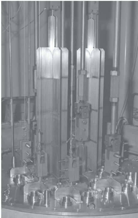
第9図 MCF 炉心に挿入された制御棒
