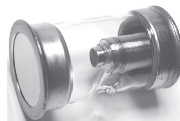
第5図 カートリッジ型マルチアルカリ光陰極電子銃
