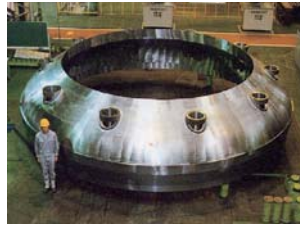
第18図 ABWR/下部鏡板 リングの完成状況
