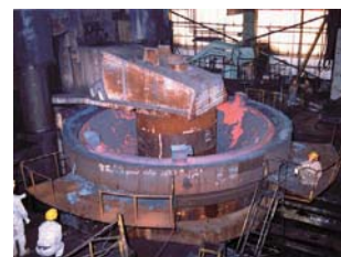
第11図 BWR 広角一体型ボトムヘッドの熱間成形状況
