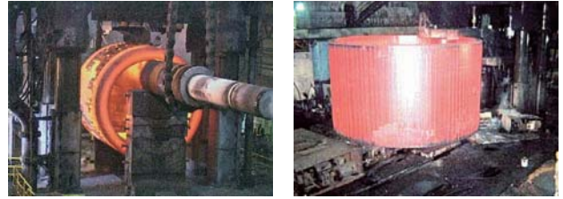
第8図 プレス機内・機外鍛錬状況
