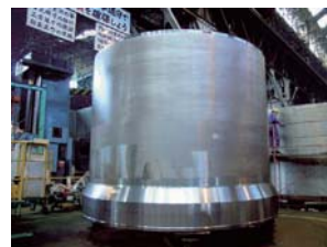
第16図 AP-1000/アッパーシェルの完成状況
