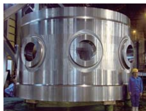
第15図 EPR/ノズルシェルの完成状況
