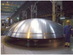
第17図 ESBWR/ボトム ヘッドの完成状況
