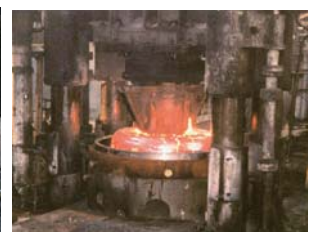
第10図 ノズル付きヘッドの鍛錬状況
