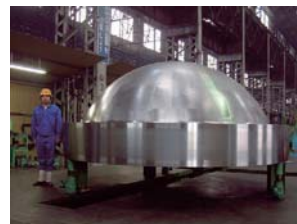
第14図 フランジ一体型クロージャーヘッドの完成状況
