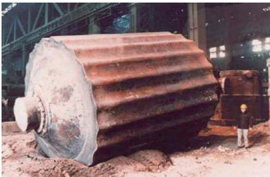
第7図 600トン鋼塊の外観
