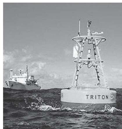
海洋地球研究船「みらい」が太平洋の西部赤道海域に設置したトライトンブイ：ブイの直径2.4 m, 高さ1.54 m, 重量2.4 トン, 緊張係留方式<sup>2)</sup>
