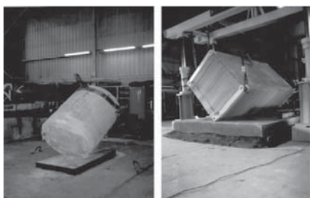
第5図 再利用金属粒骨材コンクリート製容器の落下試験
