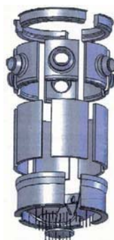
ランチョセコの原子炉容器を切断した事例 工期9ヵ月、費用610万ドル、切断工数24,000人時、作業被ばく6.4レム
