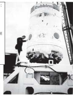
第13図 処分孔掘削工法の試験工法 7)
