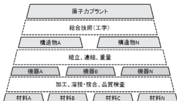
第2図 原子力プラント建造の基盤となる材料技術であるが、使用される環境により、個々の材料挙動は経年とともに異なっていく。
