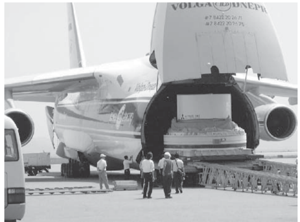
第7図 上部原子炉容器の輸送
