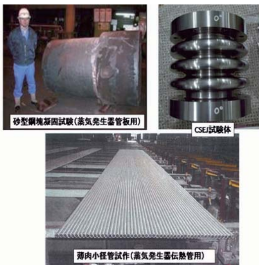
第2図 蒸気発生器主要構造の9Cr鋼による試作 2)
