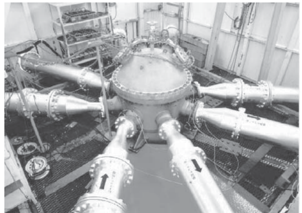
第3図 炉内構造物総合流動試験
