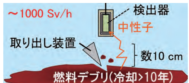
デブリ取り出し作業中の中性子計測のイメージ
