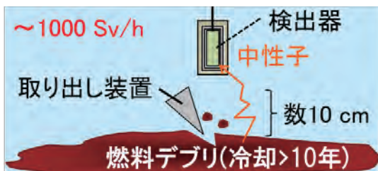
図2 デブリ取り出し作業中の中性子計測のイメージ 1)
