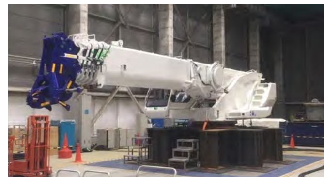
加振試験（燃料取扱機）
