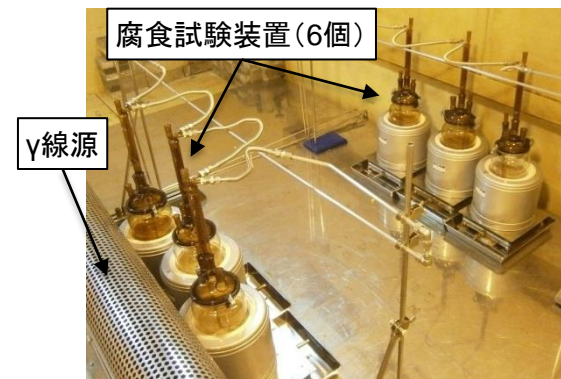
ガンマ線照射下腐食試験の状況
