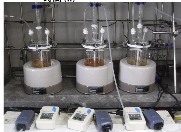
腐食試験状況(例)
