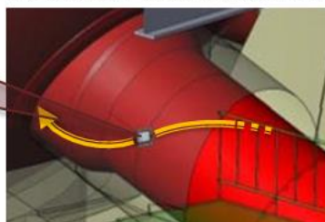
ベント管上を移動し、PCV接合部の漏えいを調査
