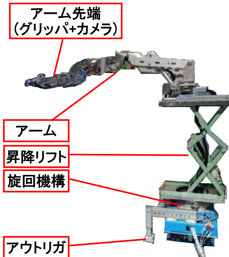
アーム・リフトを最大可動させた姿勢 (転倒有無の確認中)
