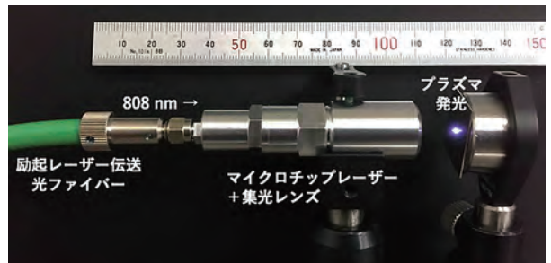
図7 マイクロチップレーザー本体試作品とプラズマ発光状況
