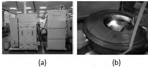
図8 レーザー粉塵処理装置(a)とレーザー除染の様子(b) (出典)稲垣ほか著, 日本原子力学会 2019 年秋の大会予稿, 2C17, 図1および図2より転載
