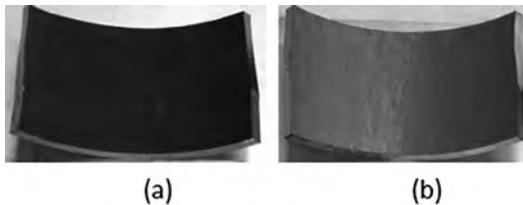
図9 レーザー除染前(a)後(b)の炭素鋼配管切断サンプル
