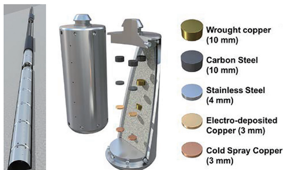
図5 MaCoTeにおける原位置試験の概念図 (出典)参考文献2), Figure 4より転載
