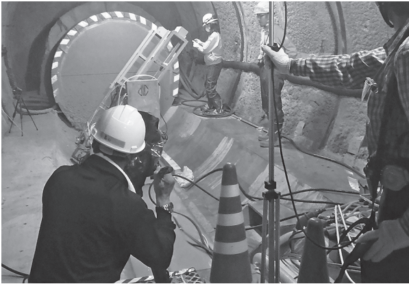
図6 試験坑道内での動画撮影の様子 (流体的方式による隙間充填材除去試験)
