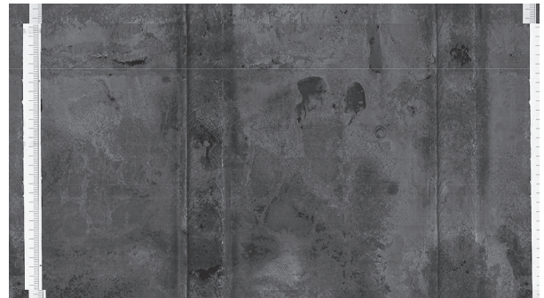
図5 円柱形状の試験体表面 展開写真の一例 縦線は180℃対向で付与したTIG溶接線
