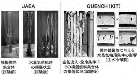
図4 模擬燃料集合体の損傷挙動試験の比較 2,3)
