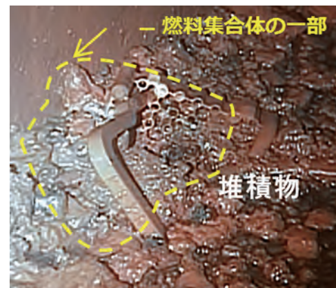
図5 ペDESTAL底部の堆積物の状況
