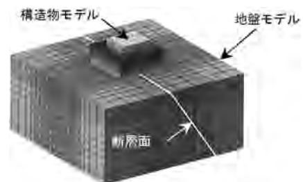
図3 構造物-地盤全体モデルの例
