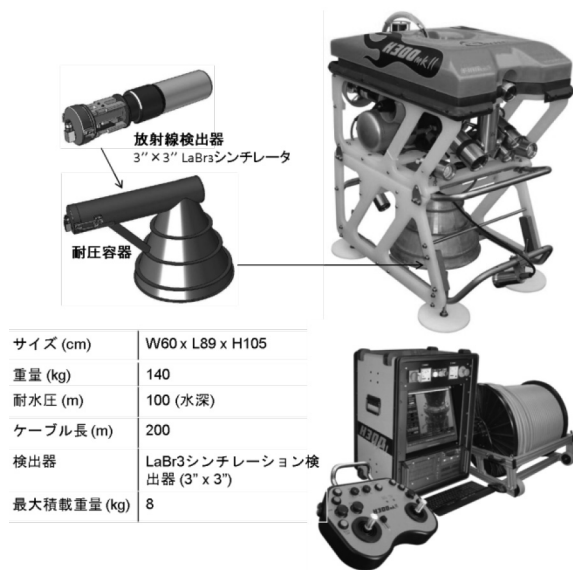
図7 原子力機構で使用している潜水型ロボットの諸元及びおよび概観(仏国 ECA Hytec 社製の H300-CBRN)
