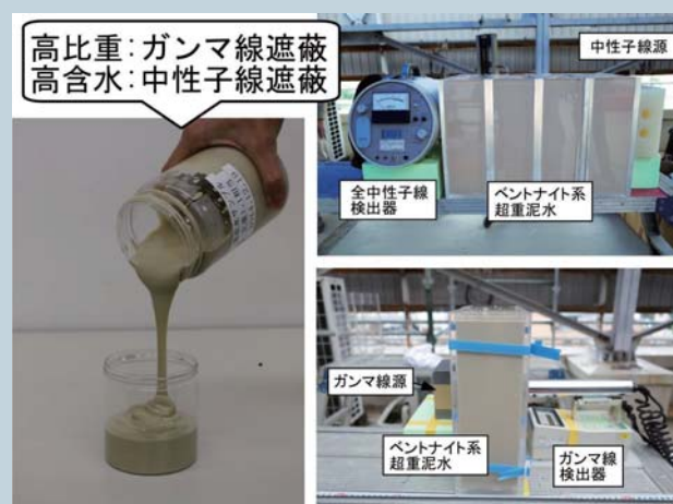
放射線遮蔽性能と遮水性能の両方を保有する土質系超重泥水の開発
