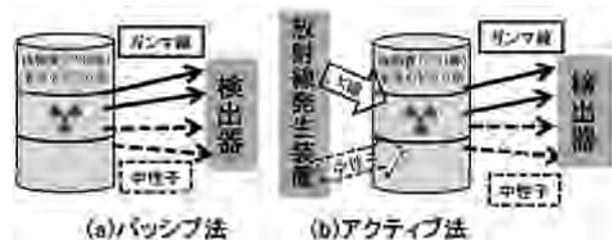
図1 パッシブ法とアクティブ法の測定原理
