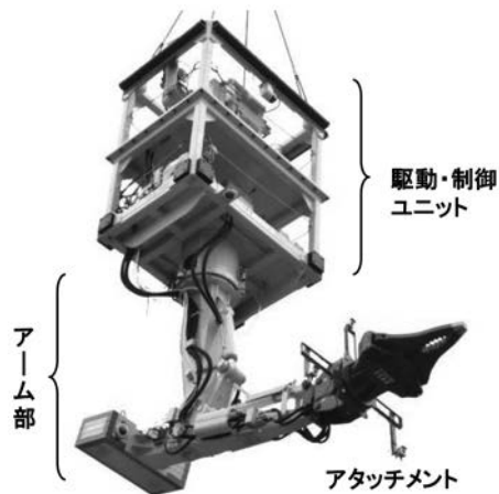
図8 装置外観 (クレーンで吊り下げて使用) 重量：約18t、駆動装置：油圧
