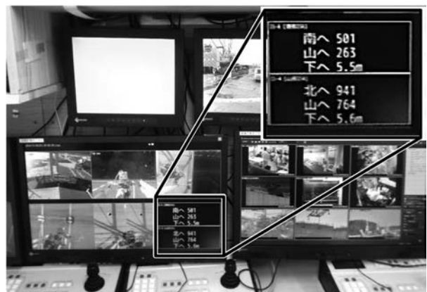
図2 誘導モニター (複数のカメラ映像，吊り治具の位置を数値表示)
