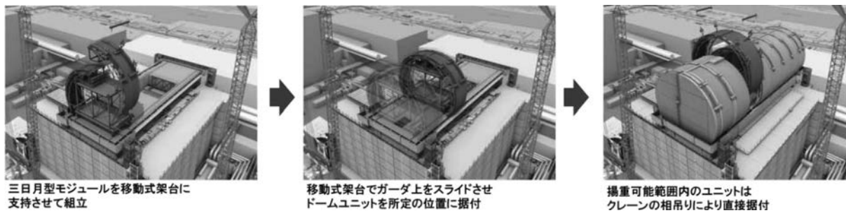
図3 ドーム屋根鉄骨の組立手順
