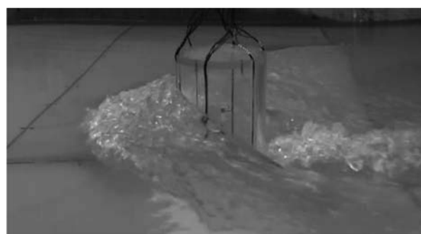
図3 タンクに作用する津波波圧に関する実験の様子 6)
