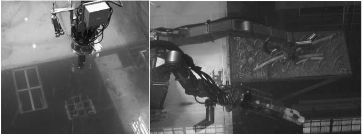
図3 訓練(左：燃料取扱訓練, 右：ガレキの移動・把持・切断訓練)(提供：(株)東芝)
