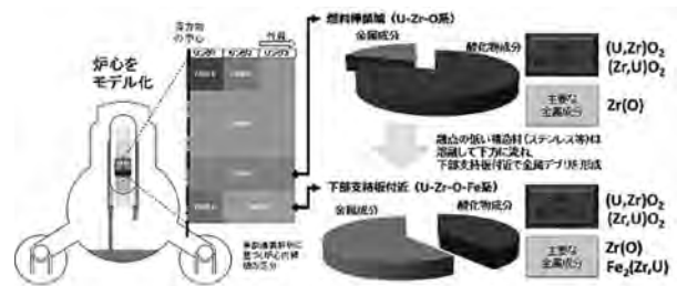
第1図 溶融・崩落後の圧力容器内の燃料デブリ生成状況
