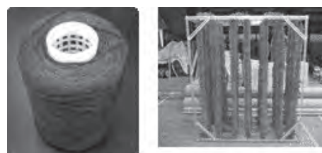
第2図 開発されたCe, Sr高性能吸着剤(斎藤教授提供)
