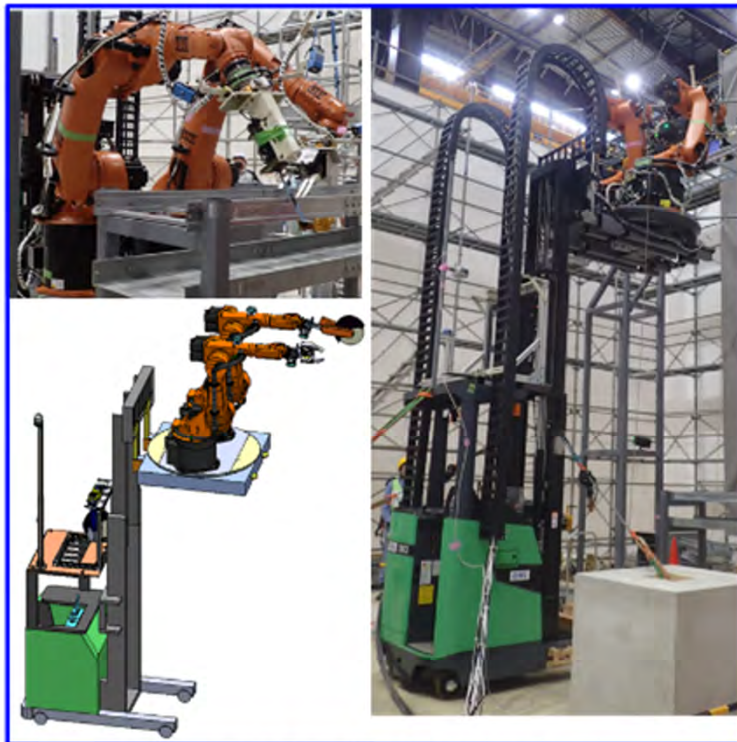
遠隔作業ロボットイメージ (写真：高所ケーブルトレイの撤去作業)
