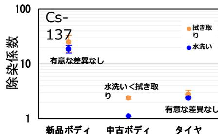
「拭き取り」と「水洗い」による車両の除染試験を実施。
