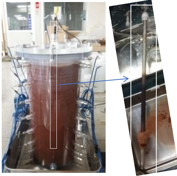
可視化模型の加熱試験 装置の外観(左)とヒータに付着した塩化物を含む吸着材(右)
