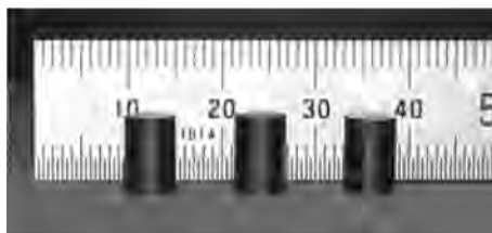
図3 5% Am 含有 MOX 燃料の焼結ペレット
