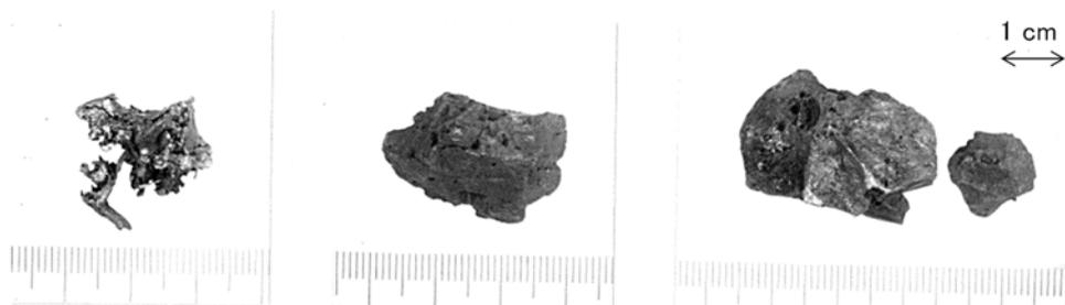
図4 TMI-2燃料デブリの例 (いずれも溶融プール形成領域から採取されたもの)
