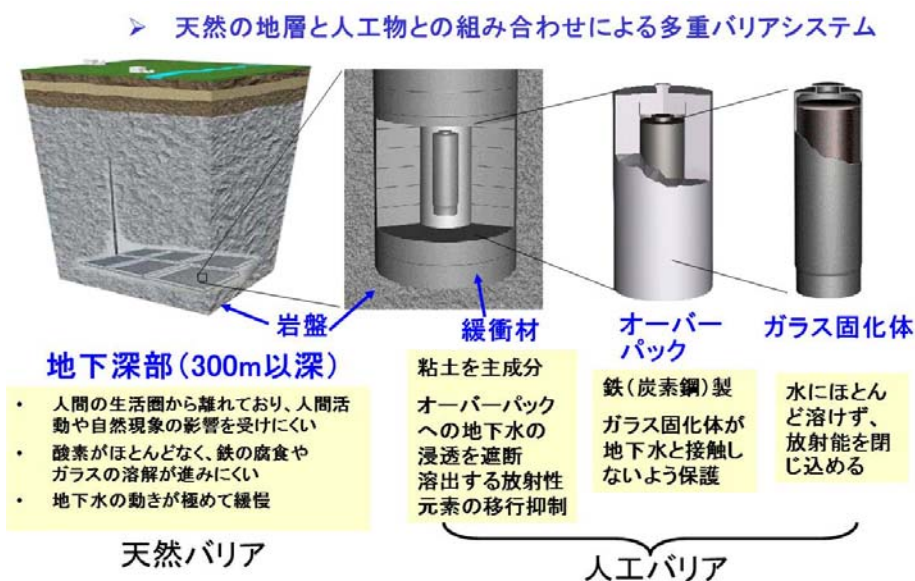
図 1.2-1 地層処分の基本概念（ガラス固化体処分の場合）
