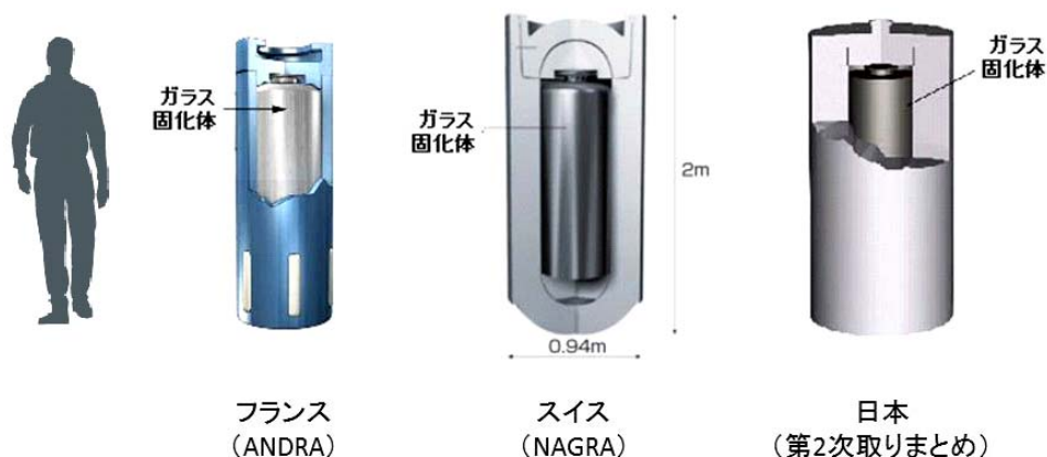
図 1.2-4 オーバーパックに密封されたガラス固化体(各国の概念)
